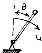
$$\begin{bmatrix} \dot{x}_1 \\ \dot{x}_2 \end{bmatrix} = \begin{bmatrix} 0 & 1 \\ 1 & 0 \end{bmatrix} \begin{bmatrix} x_1 \\ x_2 \end{bmatrix} + \begin{bmatrix} 0 \\ 1 \end{bmatrix} u$$
